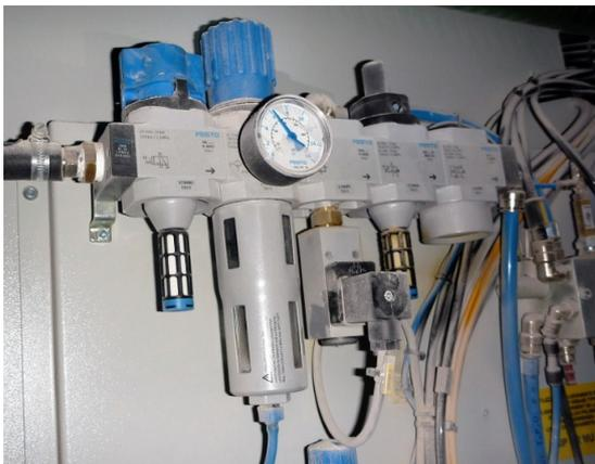
Foto 2: Druckluftverteilung grossen CNC-Fräsmaschine.
