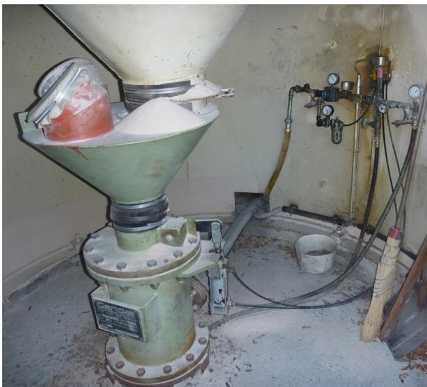
Foto 3: Pneumatischer Sandtransport
