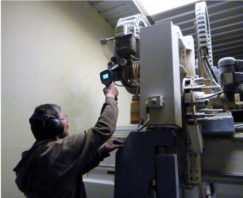
Foto 3: Lecksuche an der kleinen CNC-Fräsmaschine (Messgerät CS Instruments LD 400).
