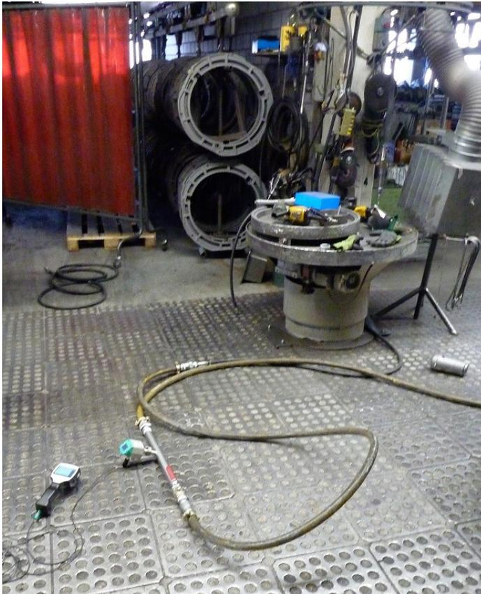
Foto 9: Messungen des Luftverbrauchs von Werkzeugen
