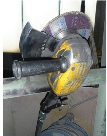
Foto 8: Pneumatischer Winkelschleifer.
