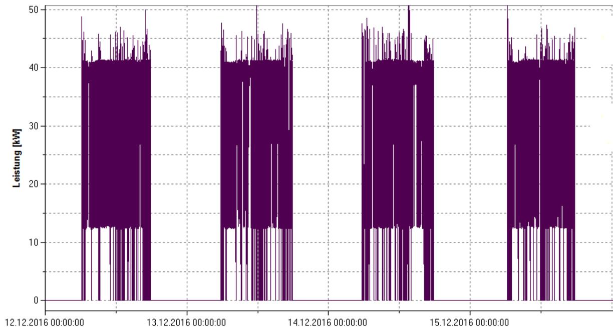
Abbildung 4: Leistungsaufnahme Kompressor 2 über 4 Werkstage. (Leistungsmessgerät: FLUKE 1738).
