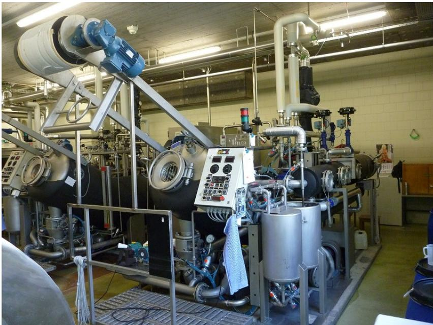
Foto 1: Eine Färbemaschinen mit vielen pneumatischen Ventilen.
