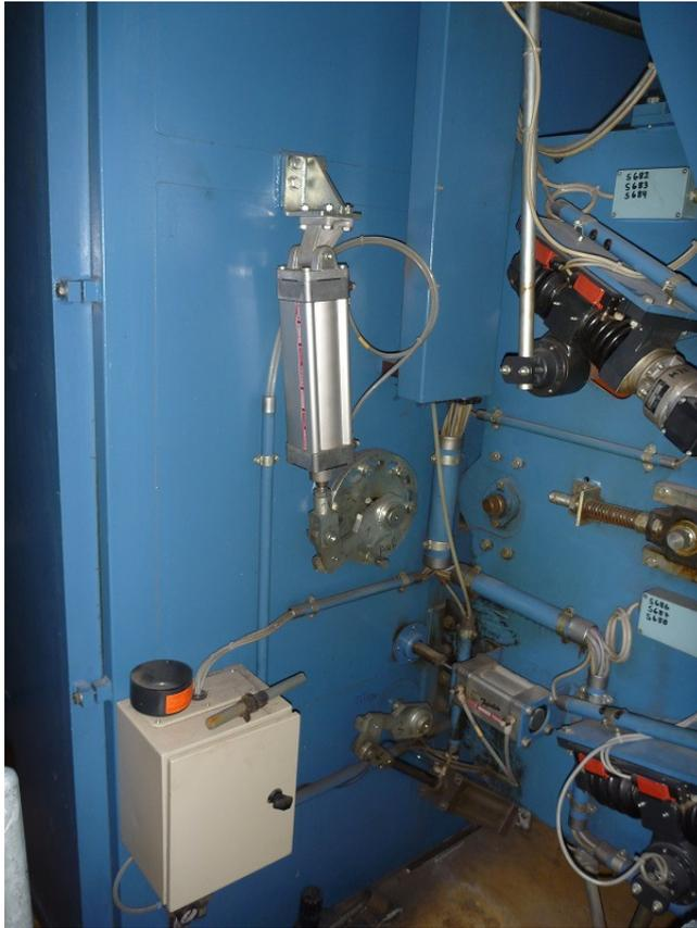
Foto 5: Druckluftzylinder am Spanrahmen.
