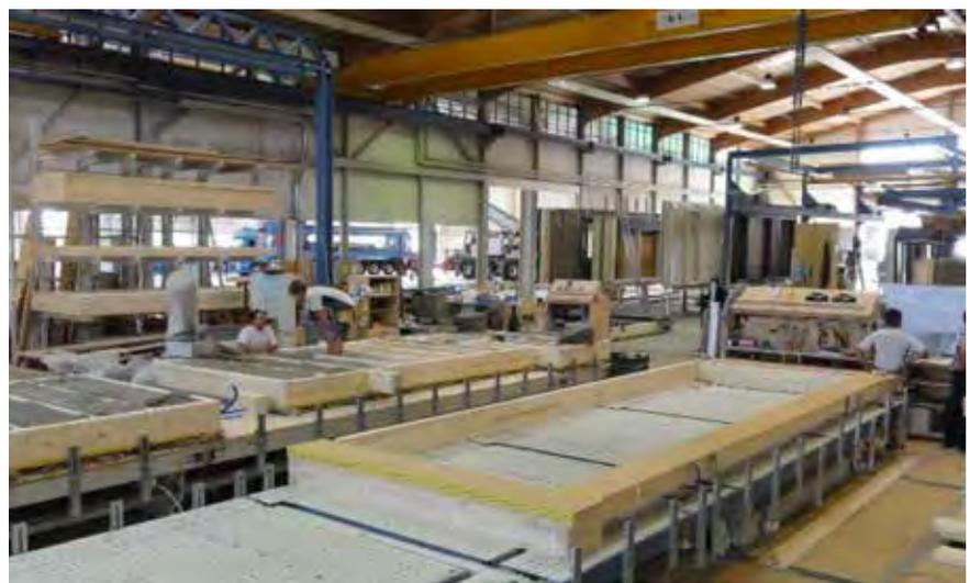
Figur 1: Vorfabrikation der Fassadenelemente für das Schulhaus Krummbach in Geuensee. Die Fassadenelemente werden millimetergenau vorgefertigt und mit Schafwolle gedämmt. Lüftungsrohre, elektrische Leitungen und Fenster werden fabrikseitig installiert. Auf der Baustelle werden die Installationen der einzelnen Module verbunden.
