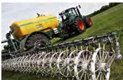
Figur 2: Beispiele von Ausbringfahrzeugen für Konzentrat. Der Tank ist direkt auf dem Fahrzeug, so dass das Pumpen ab Feldrand entfällt. (Quelle: engeli engineering et al.).
