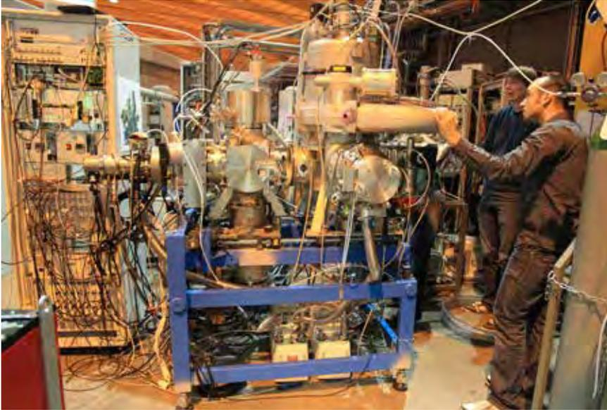
Figur 6: Aufbau der  $i^2$ PEPICO Apparatur an der für die Verbrennungsforschung eingerichteten Endstation an der SLS/UV Beamline des Paul Scherrer Instituts in Villigen. (Quelle: PSI)
