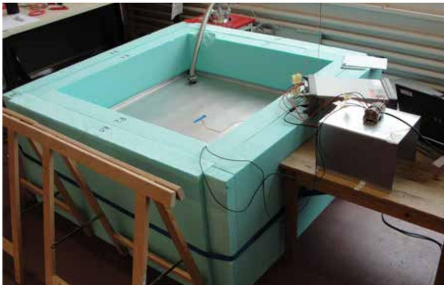
Figur 3: Messaufbau des verschlossenen 1x1 m VSI-Testpanel zur Bestimmung des Temperaturverlaufs im thermischen Beharrungszustand (Quelle: Helbling AG)
