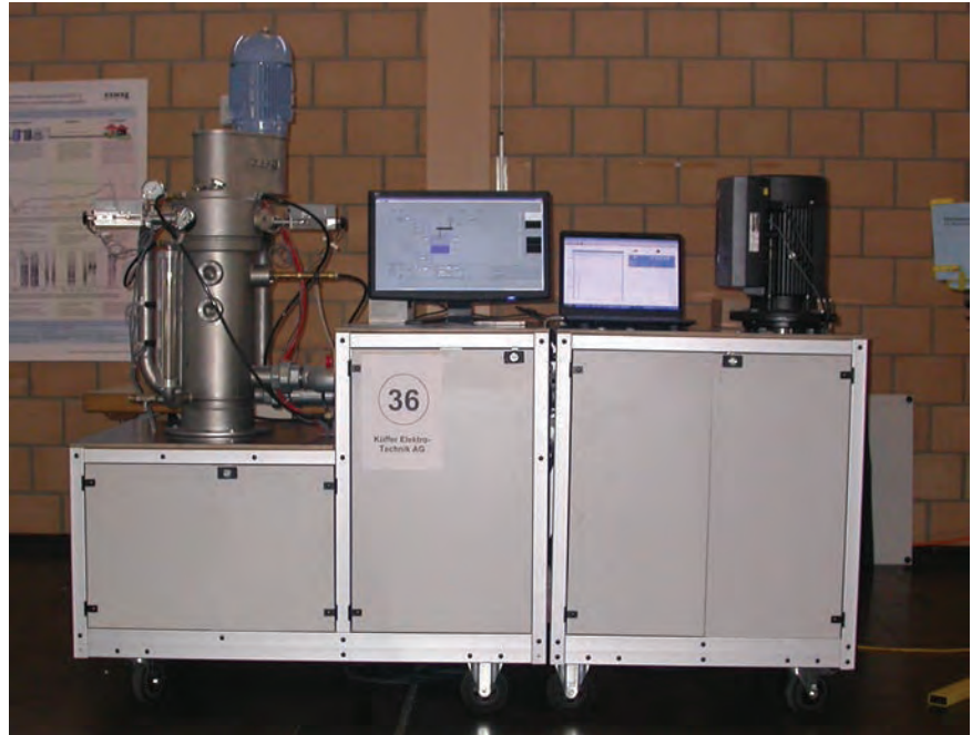
Figur 3: Versuchsturbinenwagen mit Turbinenwagen links und Tankwagen, d. h. Wassertank mit Pumpe, rechts. Das Konzept des Versuchsturbinenwagens ermöglicht den autonomen Betrieb mit eigener Wasserversorgung wie auch den Versuchsbetrieb mit Fremdwasser [10].
