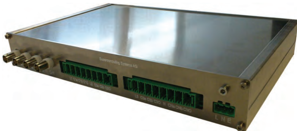
Figur 5: Der im Rahmen dieses Projektes entwickelte GridBox-Demonstrator [11] misst dreiphasig Strom und Spannung mit hoher Abtastrate und beherbergt ein uLinux-System, auf welchem komplexe Applikationen und Signalverarbeitung entwickelt werden können. Messdaten können im Rohformat während 5 Tagen kontinuierlich aufgezeichnet werden.
