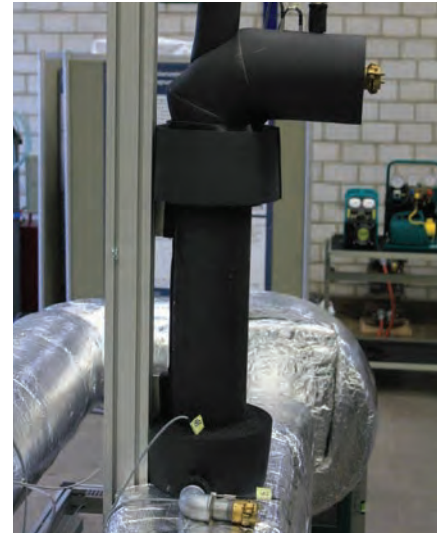
Figur 2: Thermosiphon zur Wärmerückgewinnung aus heissen, verschmutzten Abgasen – Testmodell. (Links) Thermosiphonteil zur Wärmeaufnahme aus dem «Test-Abgas» innerhalb der Prüfstrecke. (Rechts) isolierter Thermosiphonteil ausserhalb des «Test-Abgasstromes» zur Wärmeabgabe an ein Medium.
