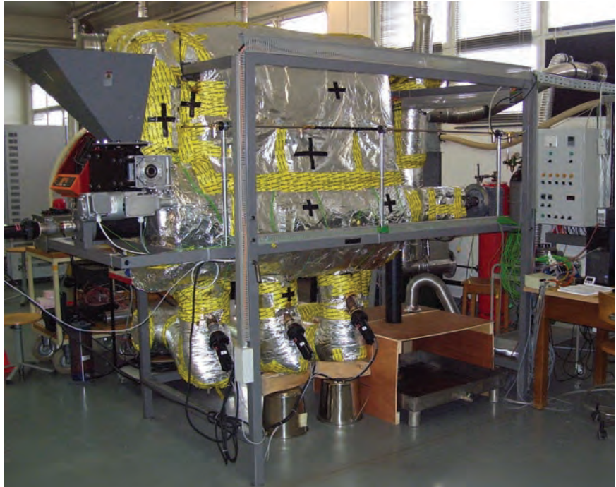
Figur 6: Pilotanlage zur Torrefizierung von Biomasse (HEIG-VD).
