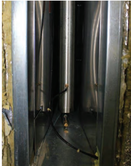
Figur 2: Thermosiphon zur Wärmerückgewinnung aus heissen, verschmutzten Abgasen – Testmodell. (Links) Thermosiphonteil zur Wärmeaufnahme aus dem «Test-Abgas» innerhalb der Prüfstrecke. (Rechts) isolierter Thermosiphonteil ausserhalb des «Test-Abgasstromes» zur Wärmeabgabe an ein Medium.
