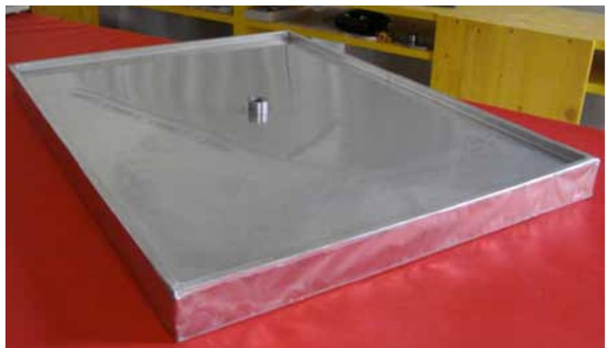
Figur 3: Funktionsmuster einer Platte mit Vakuum-Isolation mit 0.5 mm dicken Blechen und 50 µm dickem Randband aus Edelstahl (Quelle: Helbling Technik AG).
