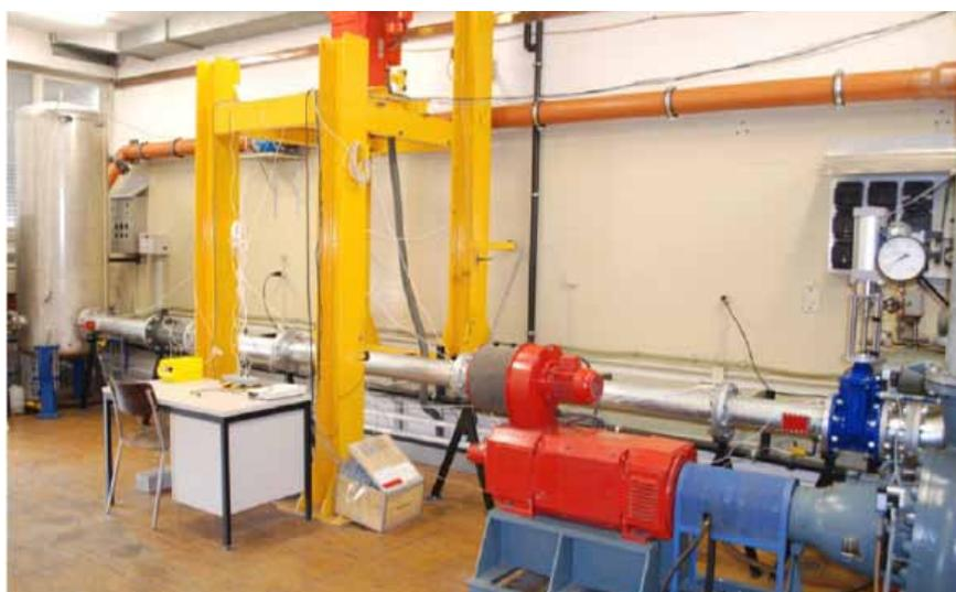
Figur 5: Der Versuchsstand zur Simulation von Druck- und Durchflussschwankungen in Rohrleitungen
