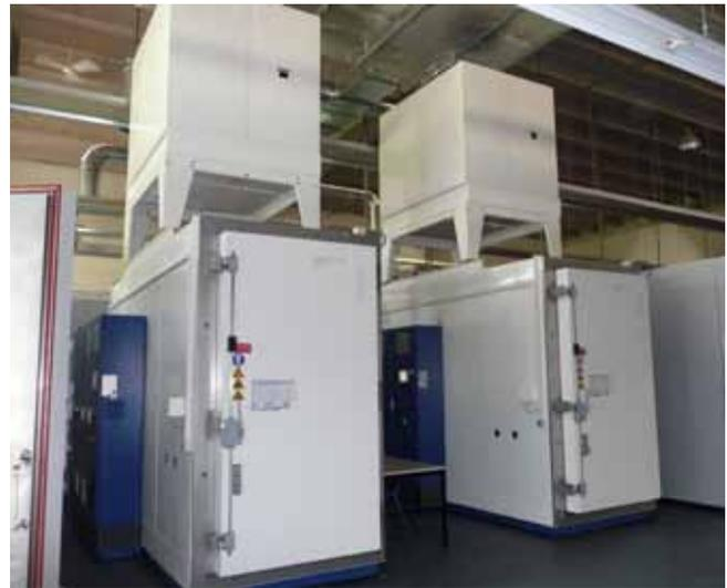
Figur 5: Zwei der drei am PV-Modultestzentrum des ISAAC in Lamone installierte Klimakammern für Klimatests von Solarmodulen. Die Abwärme der Klimakammern wird im Gebäude energetisch genutzt (Bild ISAAC).
