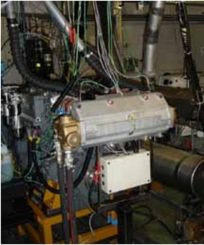
Figur 2: Prüfstand mit Liebherr 4-Zylinder-Dieselmotor D934 S mit Direkteinspritzung und Turbolader. Angebaut wurde ein Diesel Oxidation Catalyst (DOC) + Catalyzed Soot Filter (CSF) System HUG mobilclean RS. Gemessen wurde mit Brennstoffen Diesel, RME (Rapsmethylester) 7, 20, 30 und 100.
