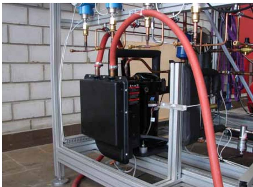
Figur 5: Inverter-Scroll Kompressor der 1. Generation mit aufgebautem Inverter im Luft/Wasser-Wärmepumpen-Prototyp [5].
