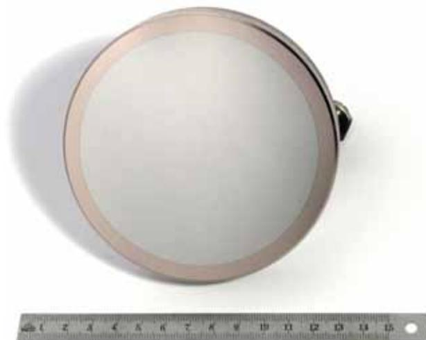
Figure 7 : maquette d'un miroir pour ITER : film de rhodium (5 $\mu$ m) sur un substrat en acier inoxydable.
