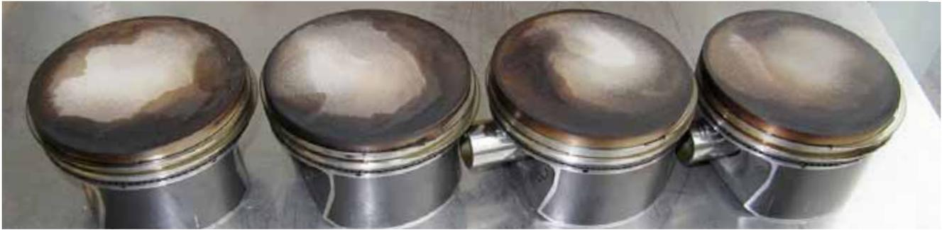
Figur 4: Die mit einer katalytischen und isolierenden Schicht versehenen Kolben eines 4-Zylinder-VW-Motors nach dem Versuch (28 Stunden Betrieb). Die dunklen Stellen am Rand stammen vom Motorenöl beim Ausbau der Kolben.
