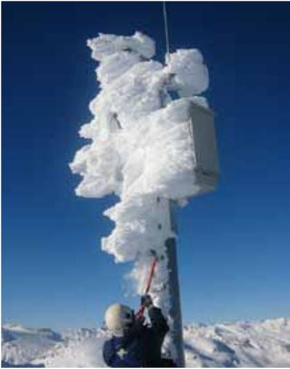
Figur 3: Vereisung an einer IMIS-Messtation (Quelle: WSL – Institut für Schnee- und Lawinenforschung).
