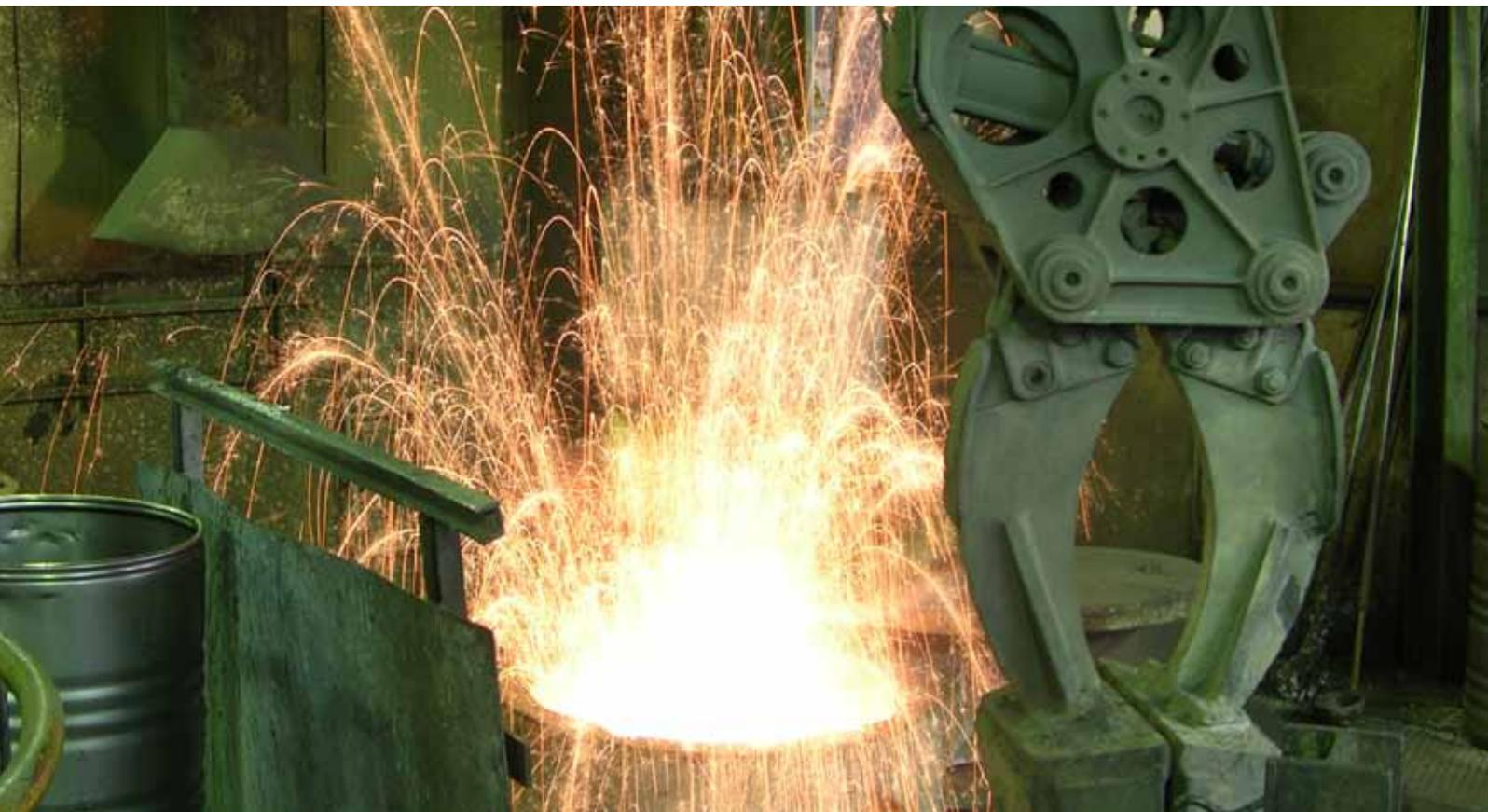
Schmelzen von radioaktiven Abfällen im CARLA-Schmelzbetrieb (Quelle: Siempelkamp Nukleartechnik)
