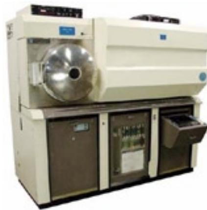
**Figur 2:** MRC Sputteranlage zur Abscheidung der Front- und Rückkontakte in 30 x 30  $\text{cm}^2$  CIGS Dünnschicht Solarzellen (Bildquelle: ETHZ)
