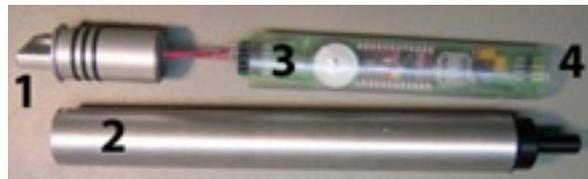
**Figur 2:** Prototyp der Sonde NIMO-T. 1: Sondenkopf mit Messfühler und O-Dichtungsringen; 2: abziehbares Druckgehäuse; 3: Datenlogger; 4: Stecker für Batterie und Datentransfer-Kabel.
