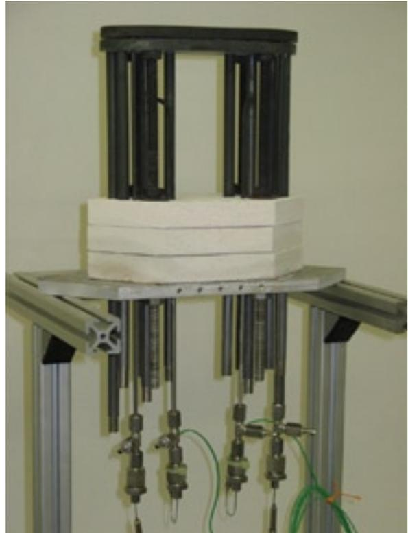
**Figur 1:** Test Set-up, der den Wärmehaushalt von bis zu 10 Zellen erfassen kann [3]
