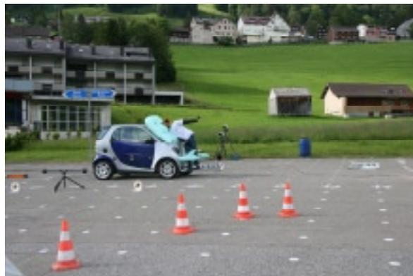
**Figur 1:** Ein Frontairbag mildert den Aufprall des Fussgängers bei einer Kollision mit einem Auto. Die neuartige Fixierung der Beine durch einen zweiten Airbag verhindert das Wegschleudern des Passanten.
