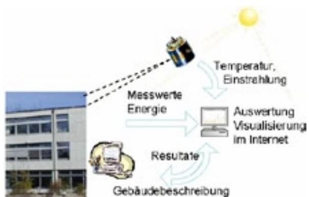
**Figur 13:** Prinzipschema von Egon (Quelle: Enecolo AG).
