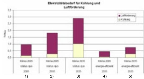
**Figur 2:** Gesamter elektrischer Energiebedarf für Kühlung und Luftförderung. Balken links: Elektrizitätsbedarf bei heutigem Technologiestandard 1) heute, 2) 2035 bei gleich bleibendem Klima, und 3) 2035 bei erhöhter durchschnittlicher Temperatur. Balken rechts: 4) und 5) Elektrizitätsbedarf 2035, unter dem Einsatz von Effizienzmassnahmen.
