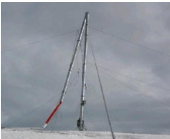
**Figur 6:** Der aufgrund von hohen Eislasten und hohen Windgeschwindigkeiten geknickter Messmast auf dem Schwyberg, Kanton FR.
