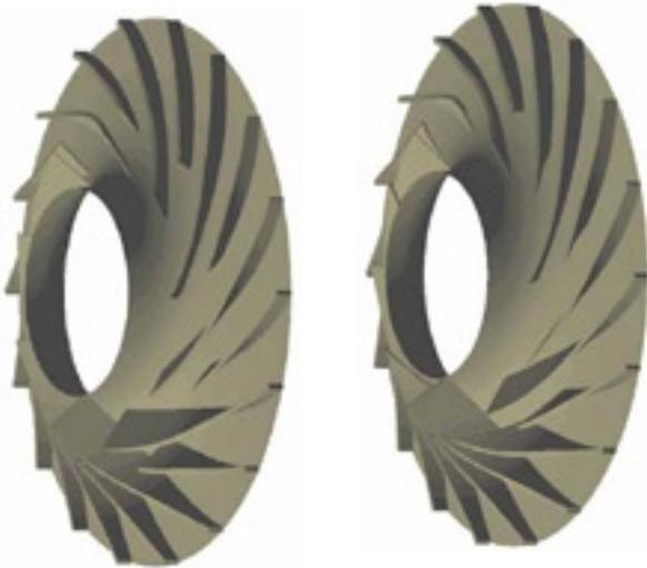
**Figur 4:** Designstudien von Laufrädern (links: mit einfacher Zwischenbeschaufelung; rechts: mit doppelter Zwischenbeschaufelung)
