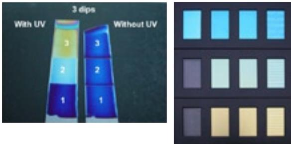
**Figure 3 :** durcissement par UV des couches minces déposées sur du verre pour les stabiliser (image de gauche) et coloris obtenus pour diverses combinaisons de couches (image de droite) [5].
