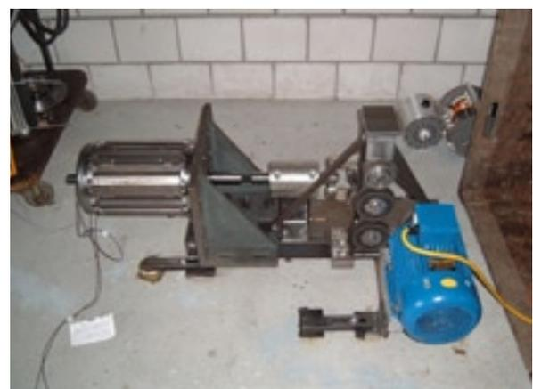
**Figur 6:** Lineargenerator auf dem Prüfstand (Circle Motor AG).
