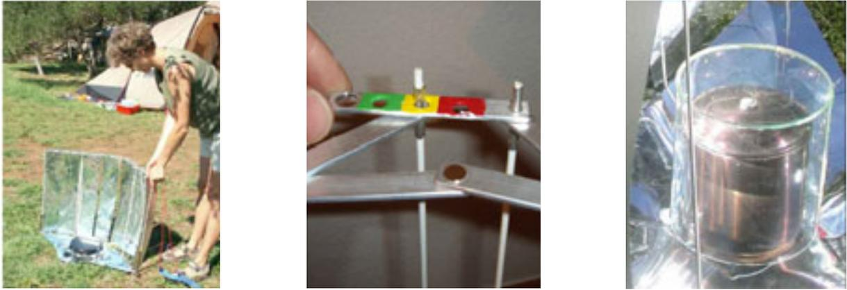
**Figure 4** : le cuiseur solaire extra léger et pliable a été testé autour du monde. Illustration de gauche: test en camping dans le sud de l'Europe. Milieu: astuce de montage selon la hauteur du soleil. Droite: sélectivité de la casserole et couverture transparente pour une augmentation importante de la température. Source : Götz.
