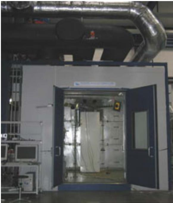
Figur 13: Akustikkabine für Aufstellung der Prüflinge.
