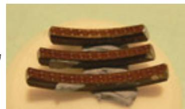
**Figur 3c:** Stahlproben nach der Laser Ablation Analyse (Kratergrössen: ca.  $200 \mu\text{m}$ ).
