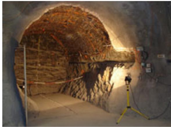
**Figur 5:** Blick in den Teststollen des EZ-B Experimentes (Länge 6.5 m, Durchmesser 3.8 m). Deutlich erkennbar ist die Spur der vor dem Ausbruch des Teststollens abgeteufte horizontalen Bohrung auf der rechten Seite des Bildes, welche zusammen mit einer weiteren Bohrung zur seismischen Charakterisierung des Gebirges dient (Quelle: HSK).
