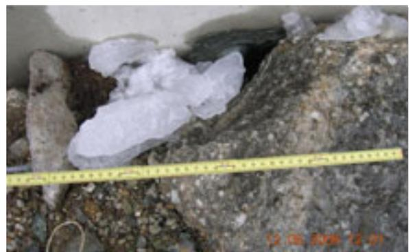
**Figur 7:** Eiswurf am Standort Güttsch, aufgenommen im Hochsommer (12.8.2006). Quelle: Meteotest.
