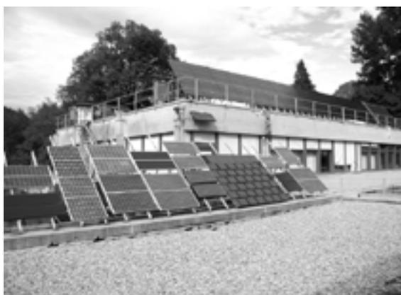
Figur 5: TISO PV Modulsteststand (Bildquelle LEEE TISO)
