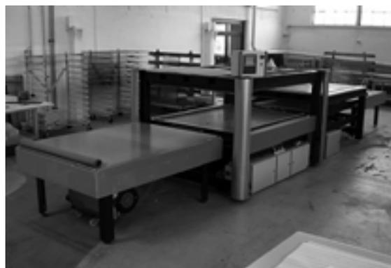
**Figur 4:** Industrielle Plasma Depositionsanlage (Bildquelle Unaxis)
