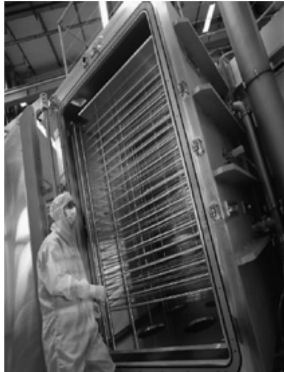
**Figur 2:** Industrielle Plasma Depositionsanlage (Bildquelle Unaxis)
