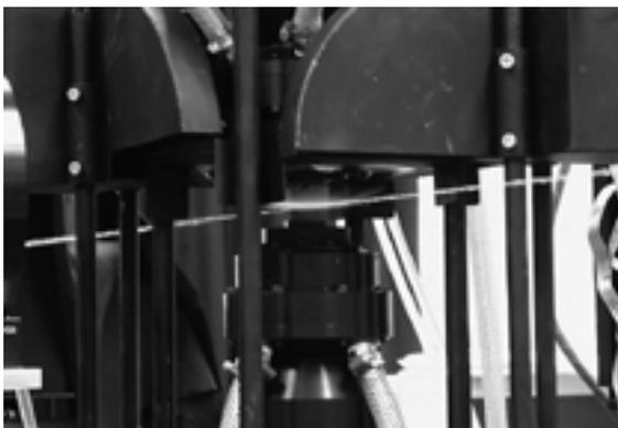
**Figur 5:** LDA-Laserstrahl misst das Strömungsprofil am Düsenaustritt des Gegenstrombrenners
