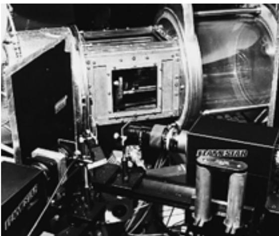
**Figur 10:** LIF-Messungen an einem modifizierten industriellen Gasturbinenbrenner
