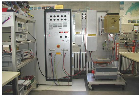
**Figur 5:** PV-Generator-Simulator 25 kW (Bildquelle: HTA-Burgdorf)
