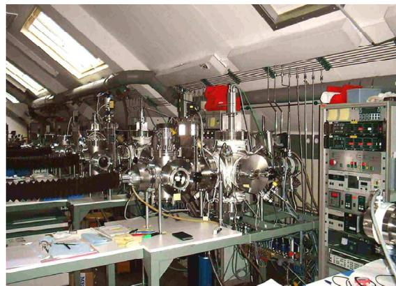
**Figur 1:** Plasmareaktoren am IMT, (Bildquelle: IMT)
