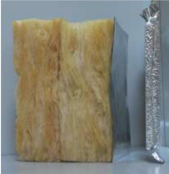
**Figur 1:** Dämmstoffpaneele mit Vakuum (im Bild rechts) dämmen bis zu 10 mal besser als herkömmliche Dämmstoffe (links). Sie haben dort ein grosses Anwendungspotential, wo der Platz für dicke Dämmschichten fehlt.
