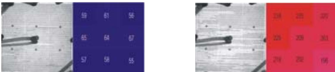
**Figur 1:** Flüssiggespeiste Direkt Methanol/Luft Brennstoffzelle, 100 cm<sup>2</sup> aktive Fläche, paralleles Flussfeld: Eingang Flussfeld links oben, Ausgang Flussfeld unten Mitte: Neutronenradiografie der Massenstromverteilung H<sub>2</sub>O+MeOH (dunkel) vs. CO<sub>2</sub> (hell) auf der Anodenseite (linke Bildhälften). Lokale Stromverteilung (9 Segmente, rechte Bildhälften) Zellenstrom: linkes Bild 6 A (60 mA/cm<sup>2</sup>), rechtes Bild 22 A (220 mA/cm<sup>2</sup>). (Bildquelle PSI)
