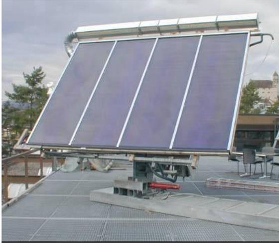
Figure 1 : banc d'essai d'un bloc capteur de 12 m<sup>2</sup>
