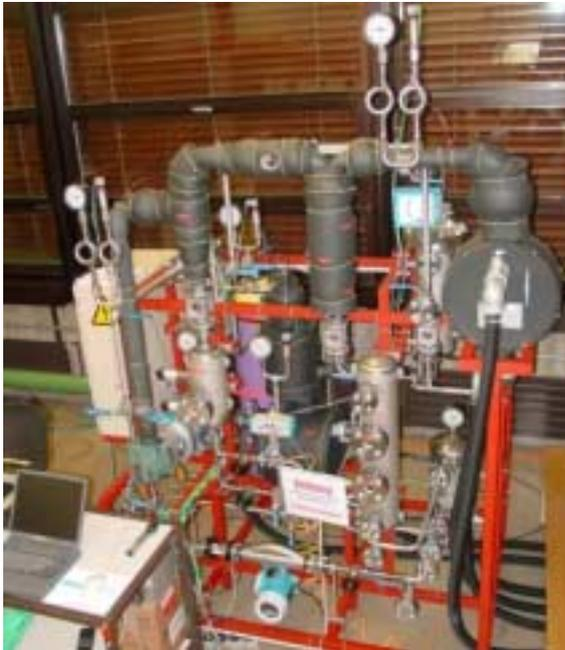
**Figur 2:** Versuchsanlage einer Ammoniakkleinwärmepumpe (aus [8]).
