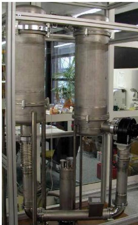
**Figure 4:** Prototype de stock en zéolithe 13X-1001 (ZEOCHEM MOLEKULARSIEB) du SPF
