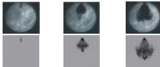
**Fig. 10:** Ausbreitung des Sprays bei  $T = 300^{\circ}\text{K}$  und  $p=5.4$  bar (Experiment und Simulation).
