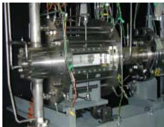
**Fig. 2 :** Hochdruck-Brennkammer mit Abgassystem für die Untersuchung turbulenter Vormischflammen
