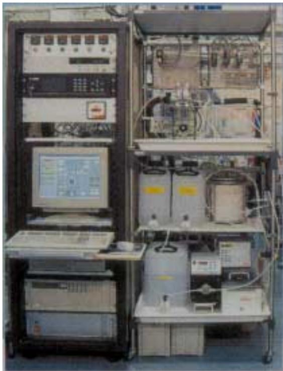
Abb. 4 Mobiler Teststand für Direkt-Methanol-Brennstoffzellen
