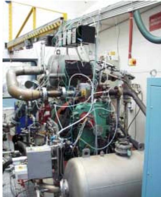
**Fig. 1:** Einzylinder-LIEBHERR Dieselmotor mit Abgasrückführung Prüfstand am LVV der ETH-Zürich.
