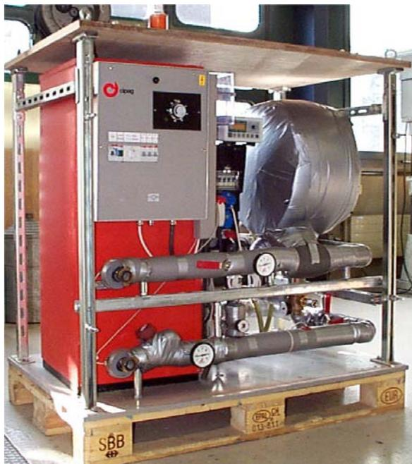
**Abbildung 5:** Responstest-Anlage der EPFL. Erkennbar Vor- und Rücklauf (Anschluss an die zu testende Geostruktur oder Sonde), Heizanlage und Expansionsgefäss.
