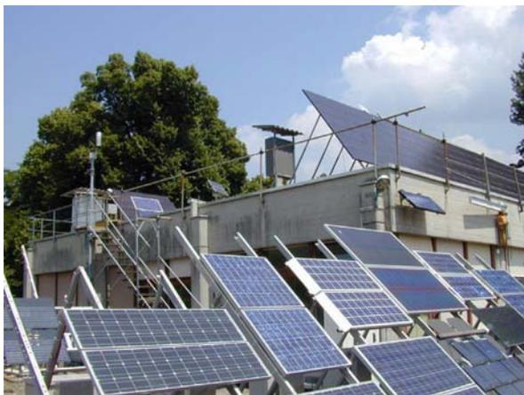
Bild 3: Teststand für Modulprüfungen am LEEE-TISO
