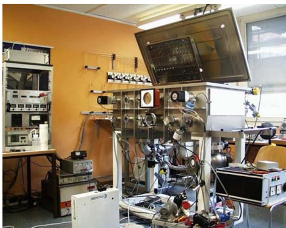
Bild 1: Roll-to-roll Reaktor bei VHF-Technologies
