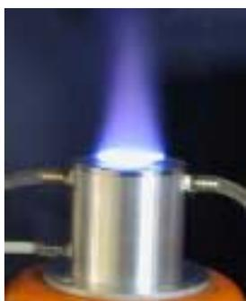
**Fig. 4:** Flächenbrenner für Raman-Eichmessungen
