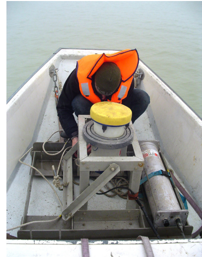
Figur 3: Feldmessungen im Grimselsee mit einem Acoustic Doppler Current Profiler (ADCP) zur Messung von vertikalen Geschwindigkeitsprofilen, die sich während des Pump- und des Turbinienbetriebs ausbilden.
