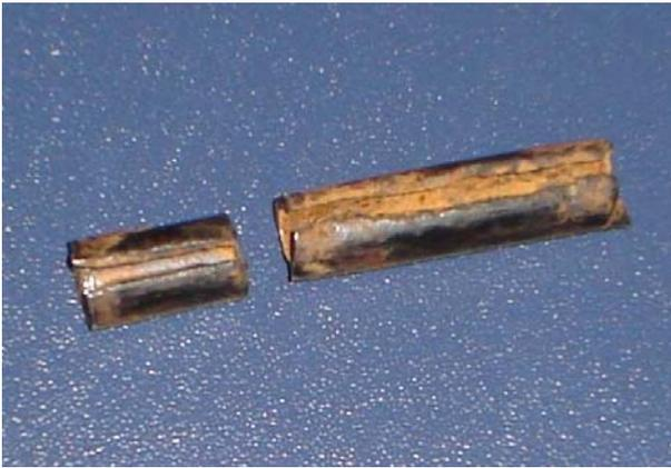
**Fig. 6: Qualität sichern ist besser als Heilen: Gebrochener Stift einer nicht normkonformen Druckrohrklappe. Bild: Entec**
