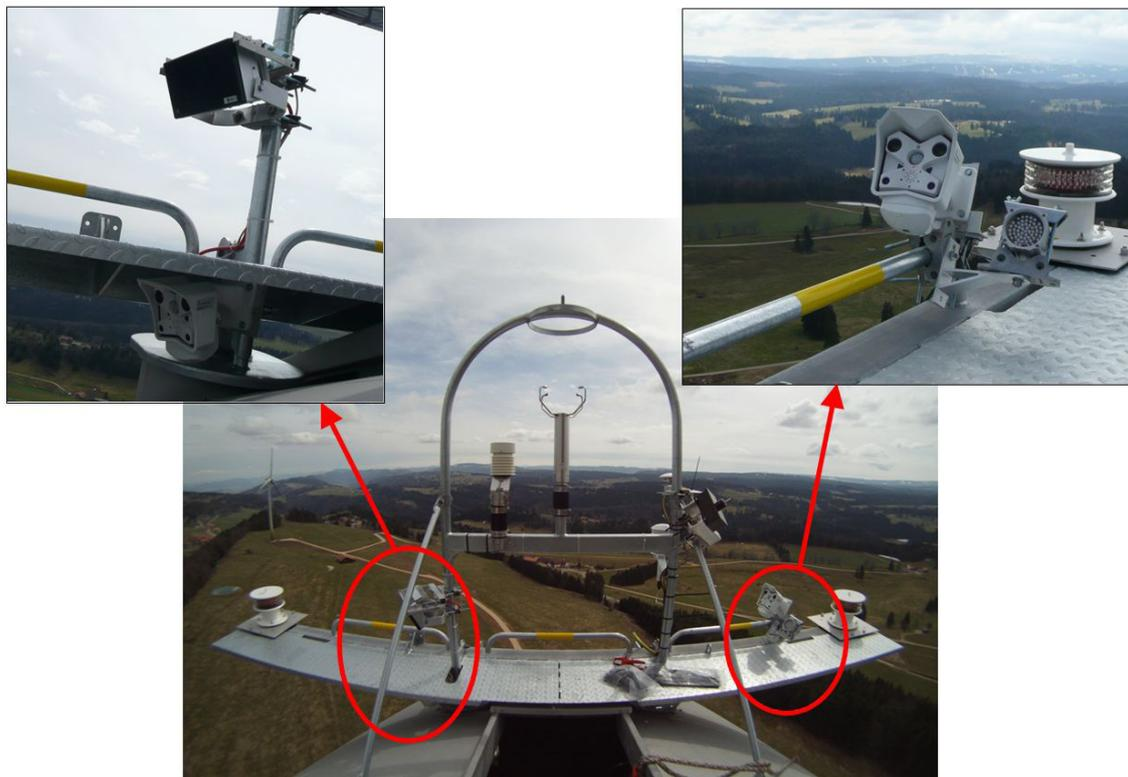
Figur 1: Installierte Kameras und IR-Scheinwerfer auf der Gondel der Windenergieanlagen in St. Brais. Links: auf das Rotorblatt gerichtete Kamera. Rechts: auf die Sensoren gerichtete Kamera.
