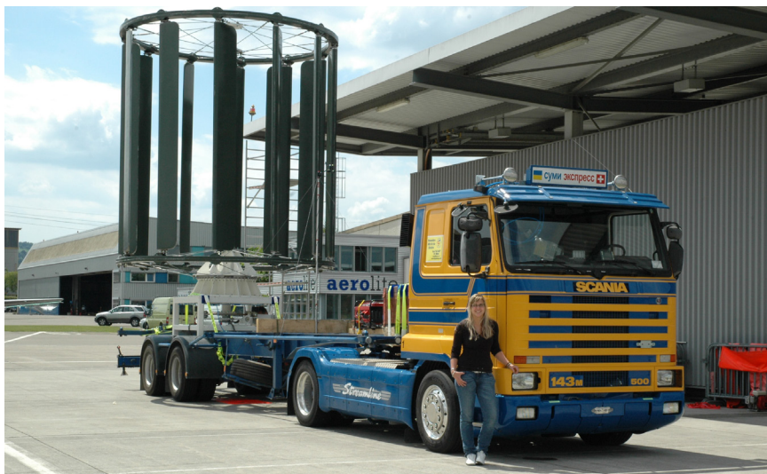
Figur 3: Versuchsaufbau zur Ausmessung des neuartigen Windturbinenkonzeptes auf dem Militärflugplatz Dübendorf (Quelle: AGILE Windpower AG).
