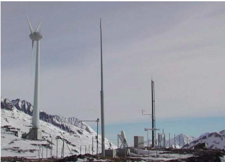
**Figur 3:** *Alpine Test Site Gütsch, mit einer 600 kW-Windkraftanlage sowie einer Anlage zum Testen von diversen Messinstrumenten unter kalten und vereisenden Bedingungen.*
