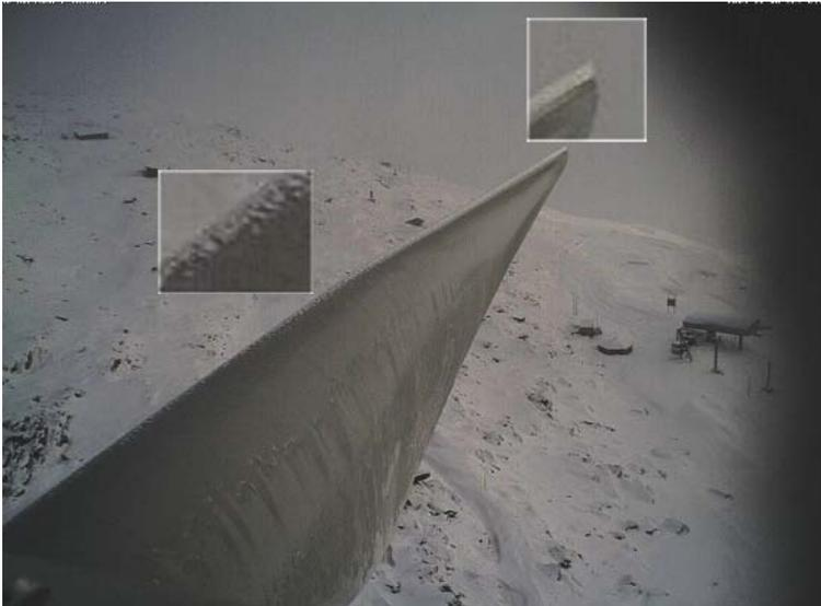
**Figur 2:** Webcam-Aufnahme der leichten Vereisung am drehenden Rotorblatt
