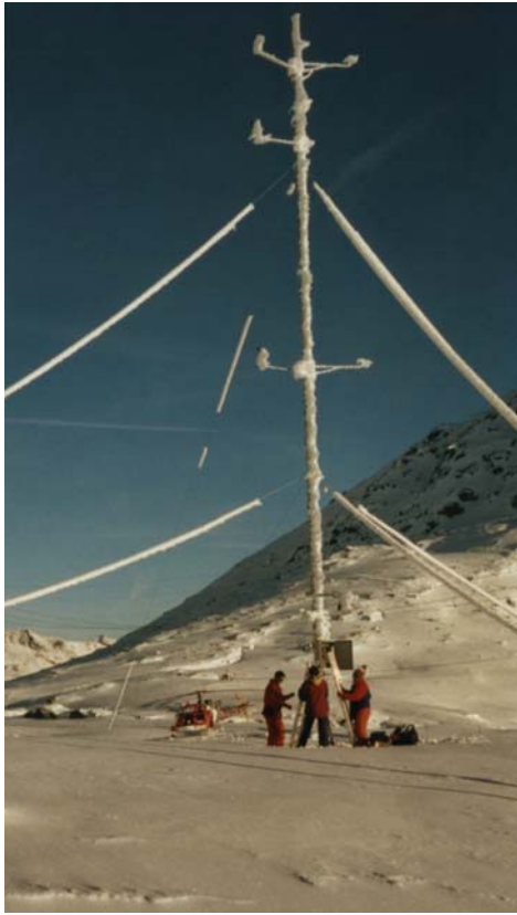
Figuren 4 und 5 Bei tiefen Temperaturen lagern sich an Messmasten und Abspannungskabeln Eis und Schnee ab, was zu grossen Lasten und grösserer Angriffsflächen bei Böen führt. Bilder von der Messkampagne auf dem Gottardpass (2'100m.ü.M.) durch NEK Umwelttechnik.
