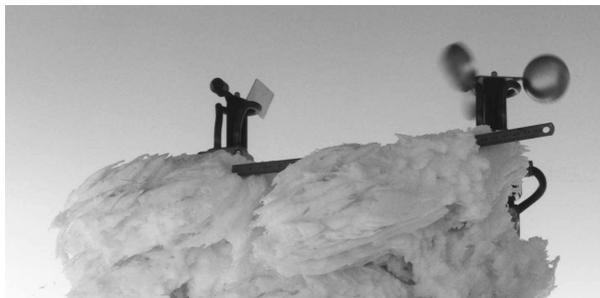
Geheizte Windgeschwindigkeits- und -richtungsgeber der Anlage Grenchenberg – nach 1 Woche Reifansatz !
