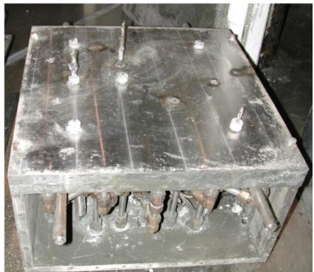
Figur 2: Zustand des Fundament-Kühlsystems, fotografiert nach WCB-1-Testende und Demontage (Quelle: OECD/MCCI-2009-TR05).
