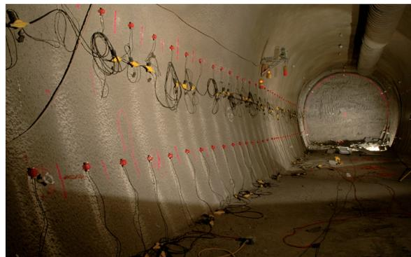
Figur 4: Instrumentierung für die Seismik-Messungen entlang der Stollenwand der Galerie-08 nach deren Erstellung und Sicherung mit Spritzbeton. (Quelle: ENSI)
