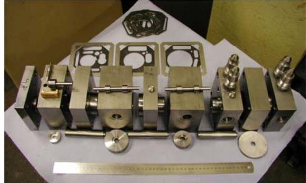
Figur 5: Einzelteile der Expansions-Kompressions-Einheit für eine CO<sub>2</sub>-Kälteanlage, TU Dresden [17]
