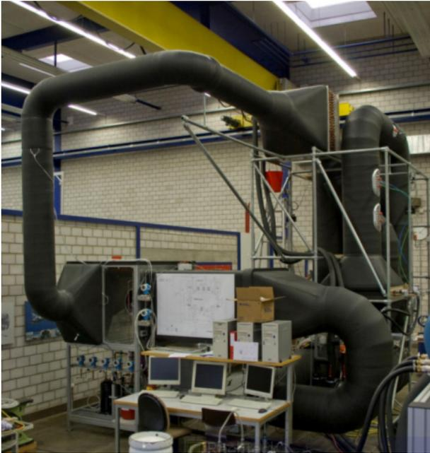
Figur 1: Prüfstand und Wärmepumpen-Prototyp im Labor der HSLU T&A [1]
