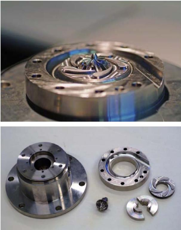
Figur 2: Bestandteile der Kompressor-Turbinen-Einheit mit maximaler Drehzahl von 250'000 rpm, EPFL-LENI [3]
