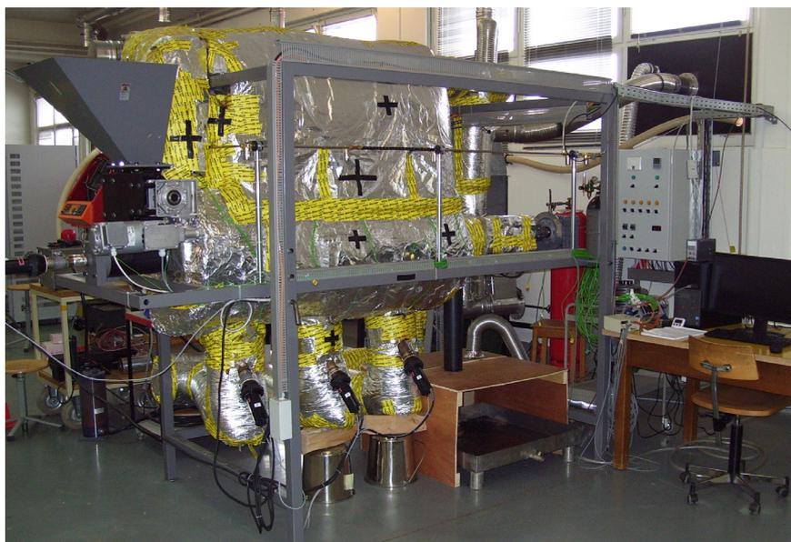
Figur 6: Pilotanlage zur Torrefizierung von Biomasse (HEIG-VD).
