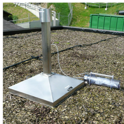
Figur 1: (Links) Beprobung einer aktiven Geruchsquelle und (rechts) einer passiven Geruchsquelle. Bei der Probenahme von aktiven Geruchsquellen wird ein Probenahmebeutel in einen Behälter gegeben (Abbildung links in der blauen Tonne), der für die Probenahme luftdicht abgeschlossen wurde. Der Probenahmebeutel wird über einen Teflonschlauch mit der Probenahmestelle verbunden. Durch Evakuierung des Behälters strömt die Probeluft direkt und unbeeinflusst (kein Kontakt mit der Pumpe) in den Beutel ein. Der Probenahmebeutel aus geruchslosem Nalophan wird so nach dem «Lungenprinzip» gefüllt. Der abgebildete Probenehmer ist für eine Probenahme von einer Minute ausgelegt. Da passive Flächenquellen nicht aktiv durchströmt werden, muss zur olfaktorischen Probenahme die geruchsemitternde Fläche mit geruchsneutraler Luft überströmt werden. Die Beprobung einer passiven Flächenquelle erfolgt mit Hilfe einer belüfteten Probenahmehaube und einem 1-Minuten-Probenehmer.
