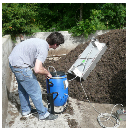
Figur 1: (Links) Beprobung einer aktiven Geruchsquelle und (rechts) einer passiven Geruchsquelle. Bei der Probenahme von aktiven Geruchsquellen wird ein Probenahmebeutel in einen Behälter gegeben (Abbildung links in der blauen Tonne), der für die Probenahme luftdicht abgeschlossen wurde. Der Probenahmebeutel wird über einen Teflonschlauch mit der Probenahmestelle verbunden. Durch Evakuierung des Behälters strömt die Probeluft direkt und unbeeinflusst (kein Kontakt mit der Pumpe) in den Beutel ein. Der Probenahmebeutel aus geruchslosem Nalophan wird so nach dem «Lungenprinzip» gefüllt. Der abgebildete Probenehmer ist für eine Probenahme von einer Minute ausgelegt. Da passive Flächenquellen nicht aktiv durchströmt werden, muss zur olfaktorischen Probenahme die geruchsemitternde Fläche mit geruchsneutraler Luft überströmt werden. Die Beprobung einer passiven Flächenquelle erfolgt mit Hilfe einer belüfteten Probenahmehaube und einem 1-Minuten-Probenehmer.
