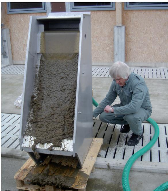
Figur 5: Bogensieb, ein Element des Membran-Bioreaktors. (Agrenum, Meritec)
