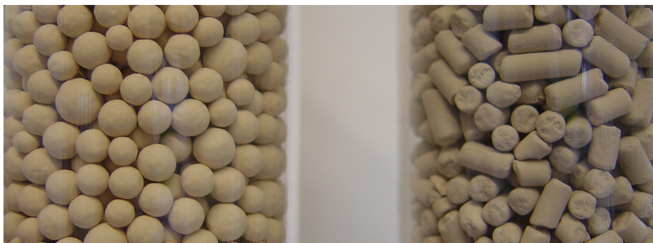
Figur 1: Bei der Firma Zeochem AG aus Zeolith-Pulver im Granulierteller hergestellte Granulate.
