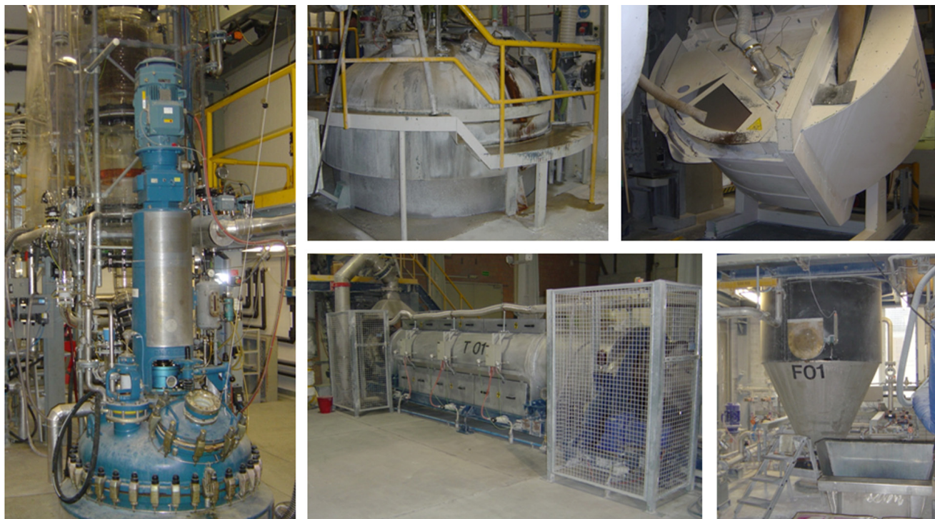
Figur 2: Apparaturen für die Zeolith-Herstellung: Säureaustausch-System zur Modifizierung von Zeolithen (links), Synthesereaktor zur Herstellung der Zeolith-Kristalle (17 m 3 , oben mitte), Granulierteller zur Herstellung von runden Kugeln (rechts oben), Drehrohröfen zum Trocknen von Zeolithpulver (unten mitte), Filtrationssystem zum Filtrieren und Waschen der Zeolith-Kristallen (unten rechts).
