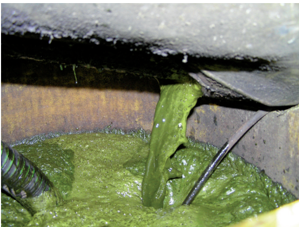
Bild 3: Das mechanische Auspressen der Pflanzenfeuchte reduziert den Energiebedarf bei der nachfolgenden Trocknung des Futtermittels und steigert dessen Qualität.
