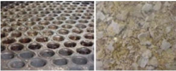
**Figur 10:** Ablagerungen im Wärmeaustauscher (Fouling).
