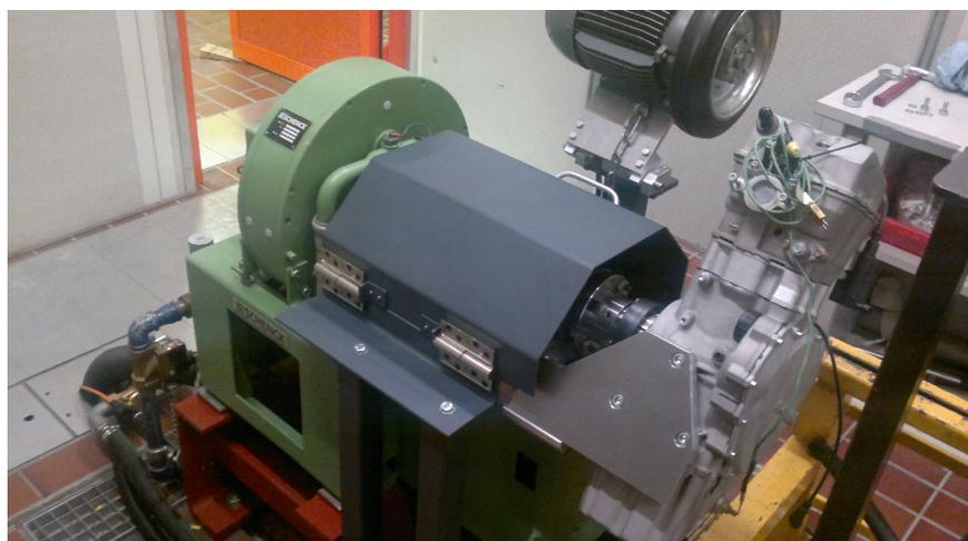
Figur 3: 1 Zylinder Motor von Wenko. Montage auf dem Prüfstand mit einer Wirbelstrombremse im Labor des LAV an der ETH in Zürich.
