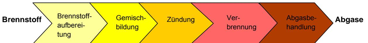
Fig. 8: Prozesskette der Verbrennung
