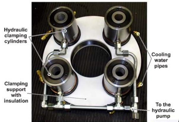
Figur 13: Klemmplatte mit den Spannzylindern für die Zylinderkopfklemmung und den zugehörigen Kühlmanschetten
