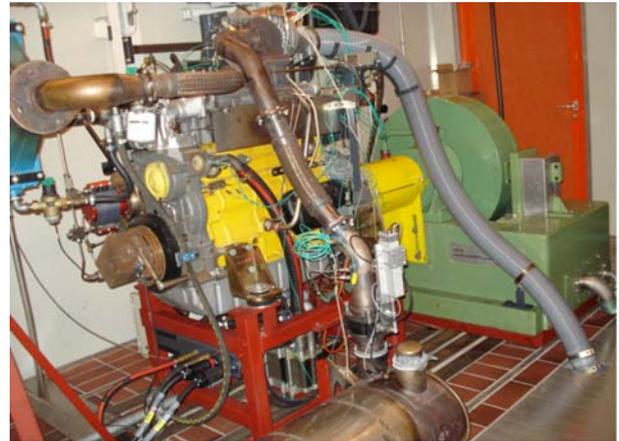
Figur 7: Aufbau des Versuchsstands mit einem Liebherr 4-Zylindermotor D 924
