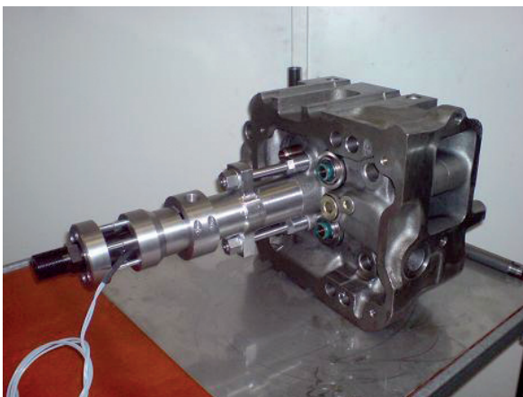
Figur 4: Modifizierter Zylinderkopf mit der Commonrail-Einspritzdüse.
