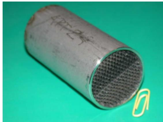
**Figur 6:** Für PCO Experimente verwendete Honigwaben strukturierte FeCr-Legierung
