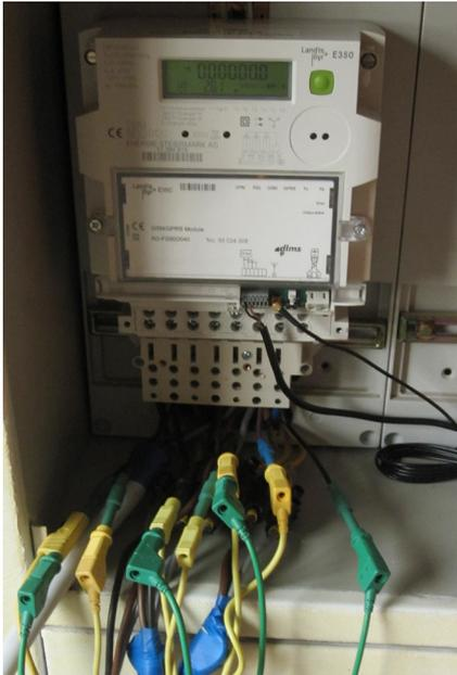
Figur 2: Messvorrichtung für den Eigenverbrauch eines Smart Meters (Quelle: Ecodesign).
