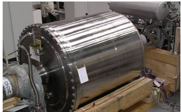
Figur 2: Rotor eines neuartigen 4000-kW-HTSL-Schiffsmotors (Quelle: Siemens).
