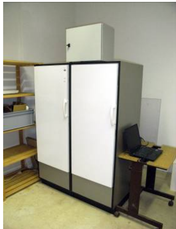
Figur 7: Aufbau mit modifiziertem und zu Vergleichszwecken belassenen A++-Kühlschrank (Quelle: awtec).
