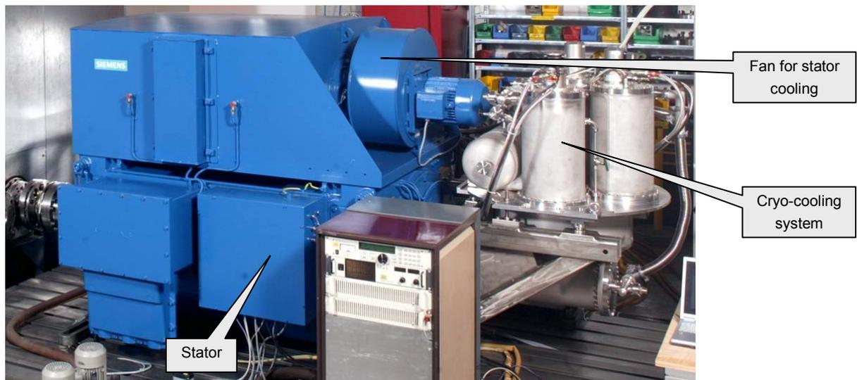
**Figur 12:** 4 MVA HTS-Generator für den Einsatz in einem Schiff (Siemens AG)
