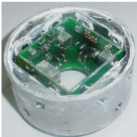
Figur 3: Rotorelektronik, Elektronikgehäuse des Integraldrives II (IDS AG)
