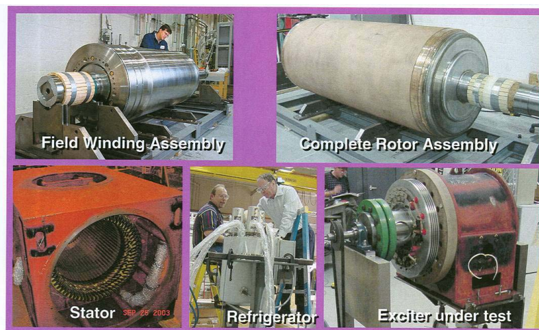
Figur 1: Komponenten eines 8 MVA-HTSL-Wechselstrom-Kompensators (AMSC)
