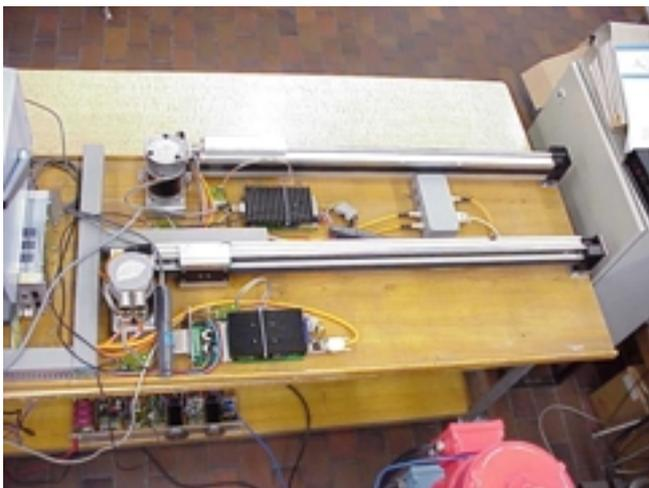
**Figur 4:** Prototyp des Schrittmotors auf dem Prüfstand (Quelle: LEAG AG)
