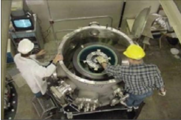
Figur 1: HTSL-Prototyp-Schwungrad von Boeing im Test (Quelle: Boeing, USA)
