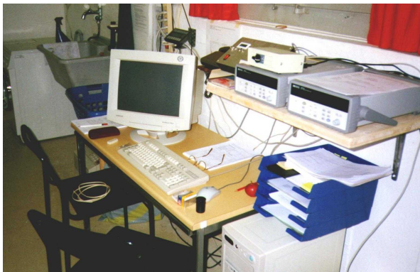
Messausrüstung des Prüfraums für Raumluf-Wärmetrockner
