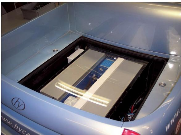
Bild 6: Das eingebaute Brennstoffzellensystem.
