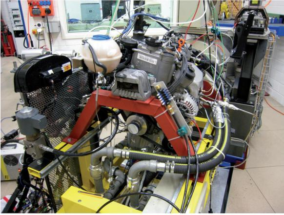
Bild 4: Der Clever Hybridantrieb: Riemenseite.
