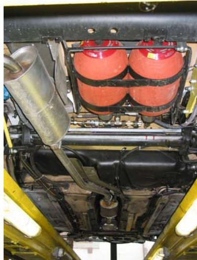
Bild 3: Pneumatischer Zwischenspeicher unter dem Fahrzeugboden.
