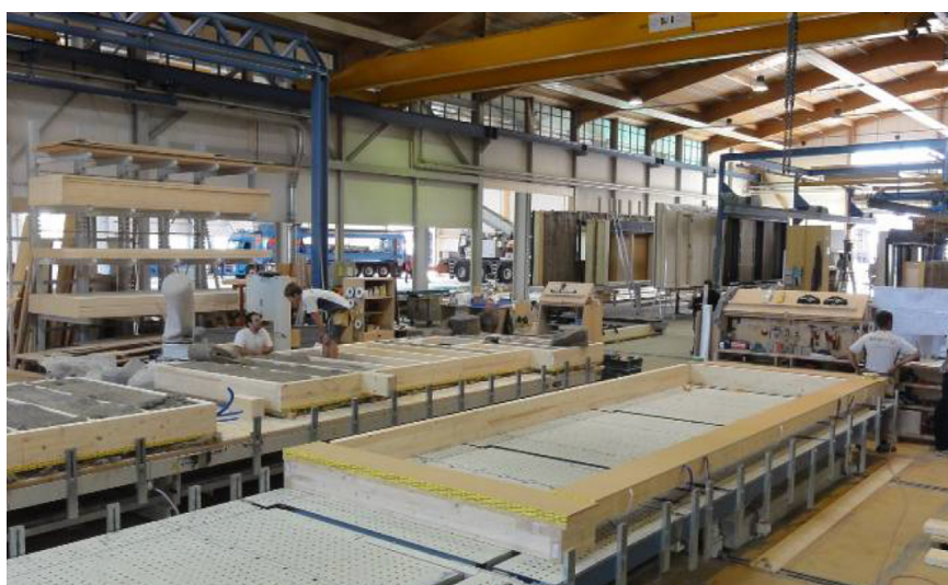
Figur 1: Vorfabrikation der Fassadenelemente für das Schulhaus Krummbach in Geunensee. Die Fassadenelemente werden millimetergenau vorgefertigt und mit Schafwolle gedämmt. Lüftungsrohre, elektrische Leitungen und Fenster werden fabrikseitig installiert. Auf der Baustelle werden die Installationen der einzelnen Module verbunden. (Quelle: Schlussbericht P+D-Projekt 500648-01 Gesamterneuerung Wohn- und Schulhaus Krummbach, EMPA Januar 2012).
