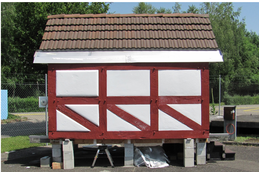
Figur 3: Bewitterungsversuche für Aerogel-Dämmputz: An einem Teststand wurden Bewitterungsversuche in der Klimakammer und unter realen Umweltbedingungen durchgeführt. In den Putzschichten wurden Sonden eingebaut, die während den Versuchen die Temperatur und die Feuchte in der Dämmputzschicht erfassten (Quelle: Schlussbericht BFE-Projekt «Sustainable Renovation of Historical Buildings», CCEM, März 2013 ).
