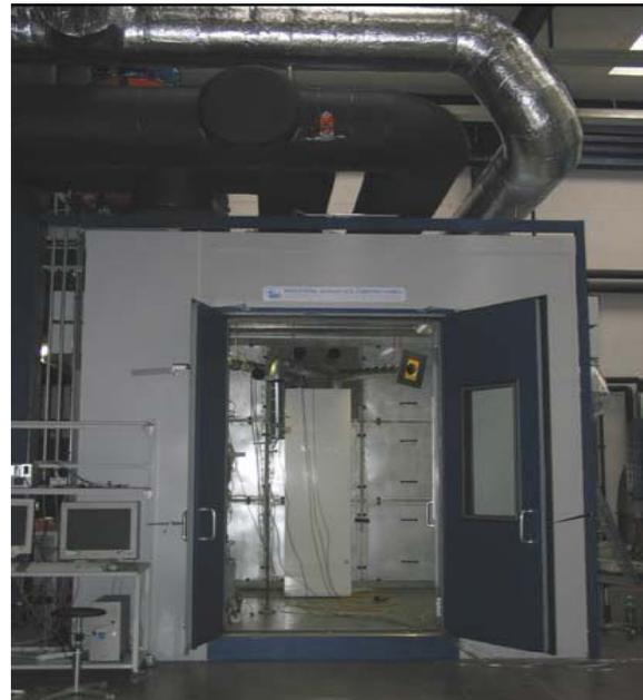
**Figur 13:** Akustikkabine für Aufstellung der Prüflinge.
