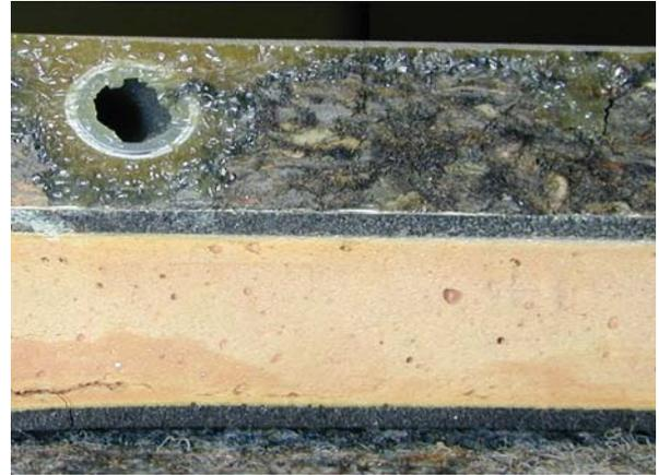
**Figur 8:** Schnitt durch ein einbaufertiges FBH-VIP-Element, totale Aufbauhöhe 51 mm (Bildquelle: Tobler AG).
