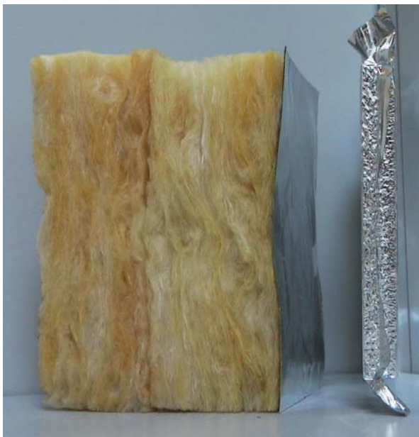
Fig. 1: Dämmstoffpaneele mit Vakuum (im Bild rechts) dämmen bis zu 10 mal besser als herkömmliche Dämmstoffe (links). Sie haben dort ein grosses Anwendungspotential, wo der Platz für dicke Dämmschichten fehlt.
