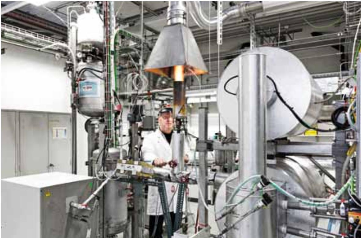
*In dieser Laboranlage stellen Forschende des PSI aus dem Naturrohstoff Holz energiereiches Gas her. Das Verfahren wandelt das Holz in synthetisches Erdgas um, das in öffentliche Gasleitungen eingespeist werden kann. Dadurch wird die Energie aus Holz für die Stromerzeugung in Gaskraftwerken oder den Autoantrieb verfügbar. Zugleich wird damit eine sehr umweltfreundliche Energiequelle erschlossen, da die Holzvergasung CO<sub>2</sub>-neutral ist. (Scanderbeg Sauer Photography)*
