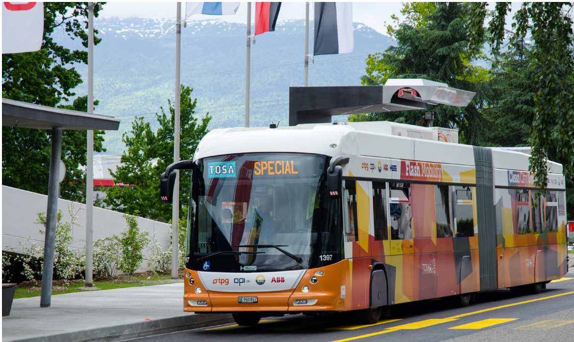
Der neuartige Elektrobuss des Konsortiums ABB, TPG, Opi und SIG vermeidet die starre Einbindung des Trolleybusses an die Oberleitung, behält jedoch die sonstigen Vorteile eines Elektrobusses. Geladen wird der Bus mittels konduktiver Ladung an den Endstationen und Schnellladungen unterwegs an bestimmten Bushaltestellen. Bild: EPFL
