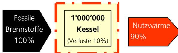
**Fig. 8: Energiefluss von fossil betriebenen Kessel**
