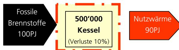
**Fig. 5: Energiefluss fossil betriebener Kessel**
