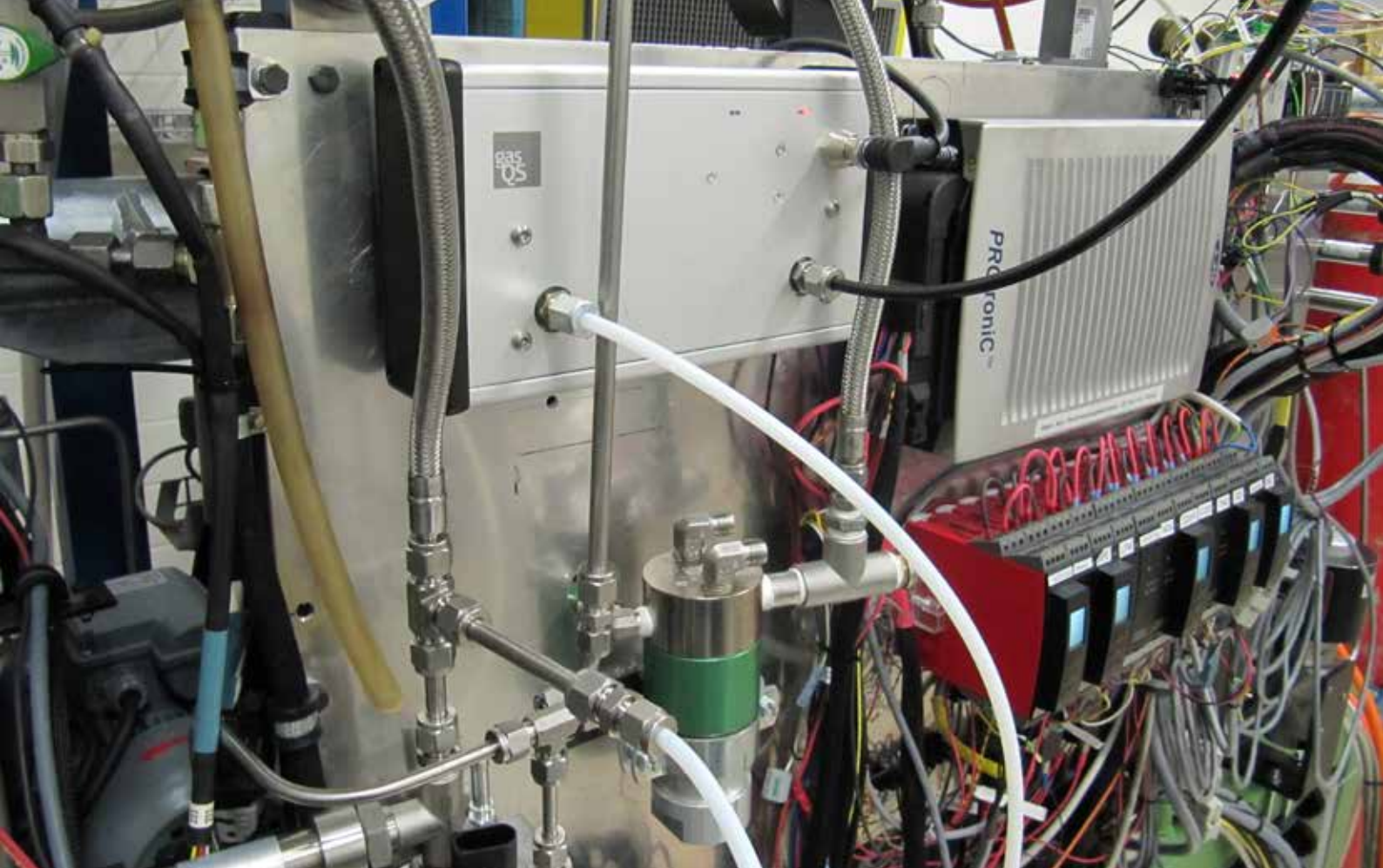
Gasbeschaffenheitssensor im Projekt «GasPot» auf dem Motorenteststand der Empa.
