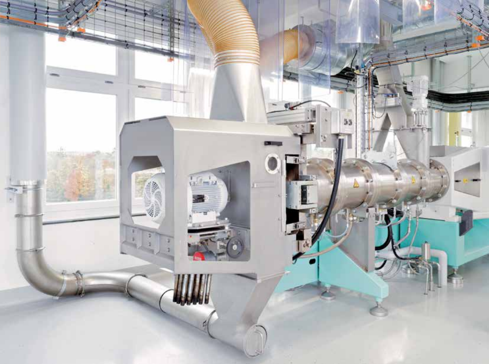
Der Extruder ist die Hauptkomponente der neuen Anlage der Meyerhans Mühlen zur Herstellung eines Stärkeprodukts für die Papierindustrie.
