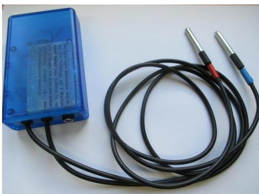
Abb. 2: Störungsmelder mit zwei Temperaturfühlern und Netzanschluss inkl. Tongeber, entwickelt für den Test an 10 Solaranlagen von Energie Zukunft Schweiz.
