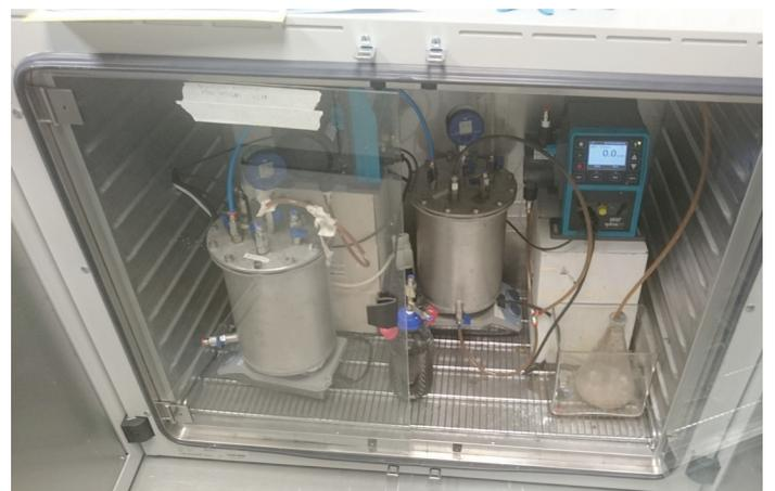
Roger König von der Fachhochschule Südschweiz hat in einem Projekt die zweiphasige anaerobe Vergärung von biologischen Industrieabfällen für die Herstellung von Biogas untersucht. Im Bild: Ein Inkubator, welcher die Reaktoren auf einer konstanten Temperatur von 36 °C hält. Foto: SUPSI
