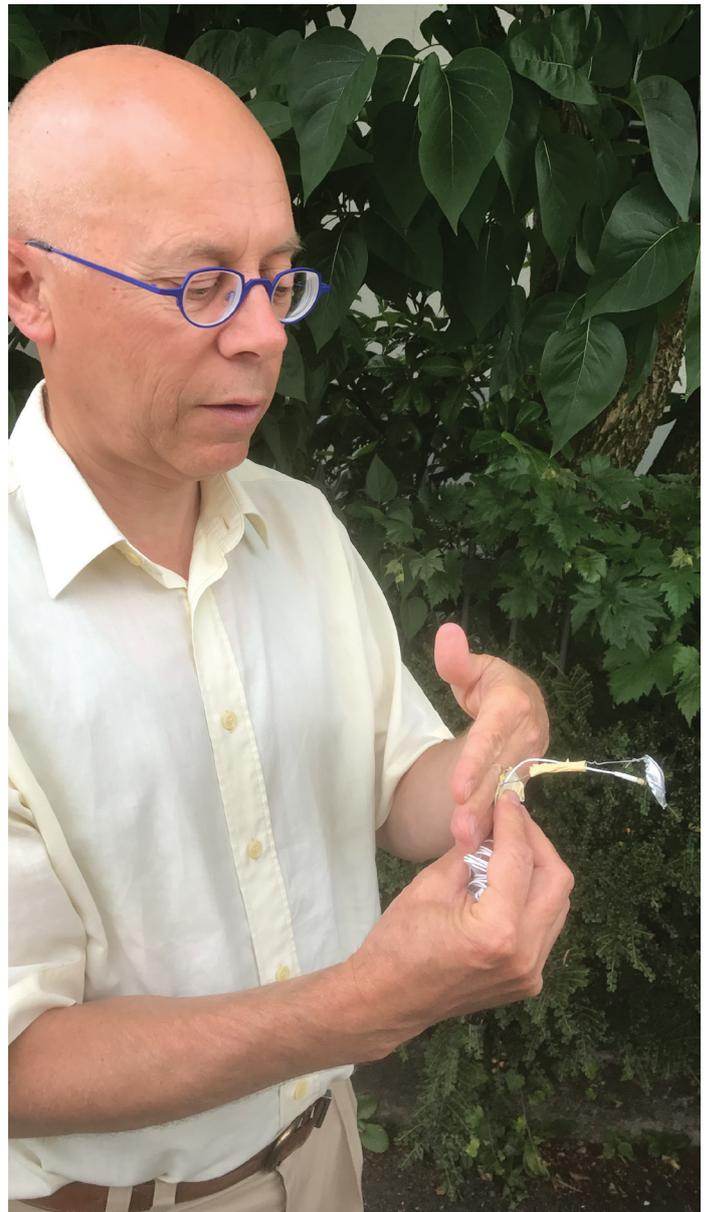
Werner Hässig, Inhaber der *hässig sustech gmbh*, zeigt, wie der Temperaturfühler des gSKIN-Messkits an der Aussenwand montiert wird, um den U-Wert zu messen. Foto: B. Vogel
